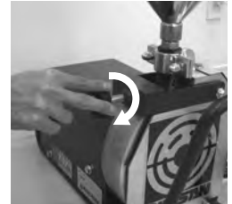
⑥圧力調整ネジを右に回す
