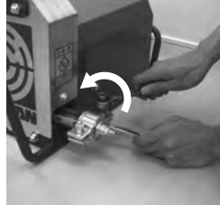
①ホッパ、ホース、チューブバンド、カップリングを取り外し、チューブのみの状態にする
