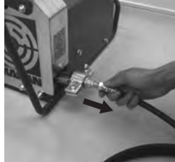
①ホッパ、ホース、チューブバンド、カップリングを取り外し、チューブのみの状態にする
