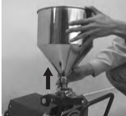
①ホッパ、ホース、チューブバンド、カップリングを取り外し、チューブのみの状態にする
