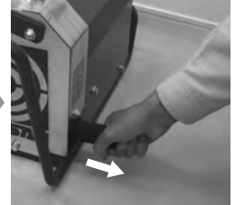
②運転しながら吐出方向に引っ張り、チューブを引き抜く
